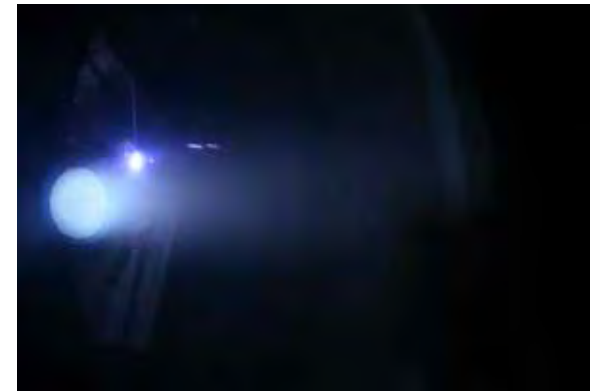
フライトモデル(スラストB)の真空チェンバ内での噴射試験の様子
