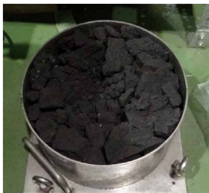
プロジェクタイトイル発射後の 模擬リュウグウ砂礫標的
