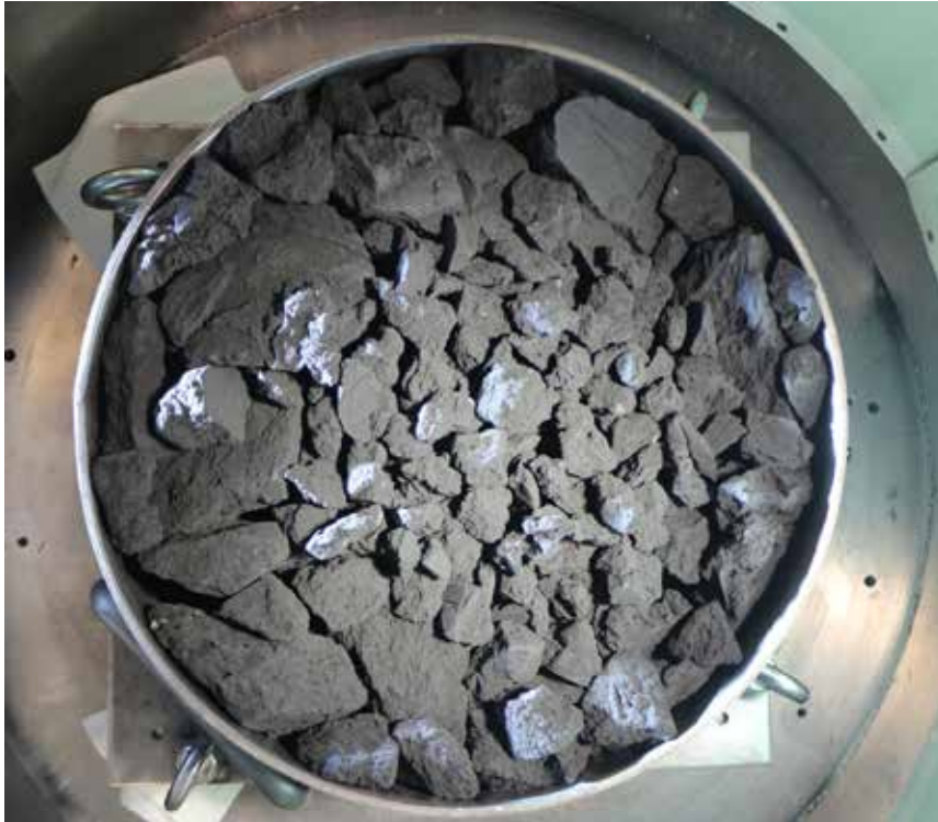
リュウグウの表面を模擬したターゲット (画像クレジット: JAXA、東京大学)
